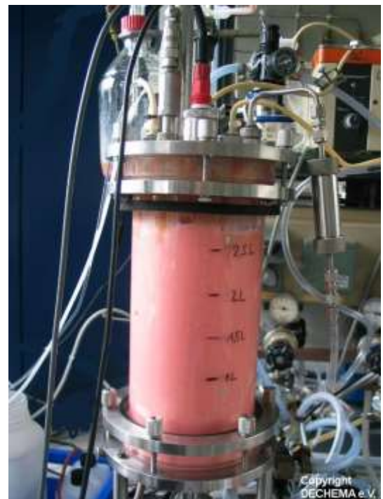
Abbildung 2: Ein Bioreaktor, auch Fermenter genannt
